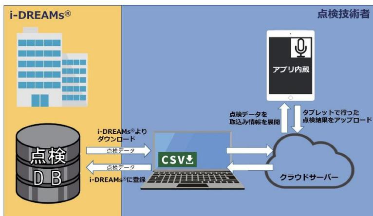
Webアプリケーションとクライアントアプリケーションによって構成される本システムは、点検システムで管理しているデータをICT端末で取り込み、情報を展開、端末で行った点検の結果をクラウド上の点検システムへアップロードする仕組みになっています。1つの入力項目に対して3つの呼称を登録することができ、現場の担当者による呼称の違いにも対応します。さらに、端末内にデータを保存することでオフライン環境下でも点検を行うことが可能です。
