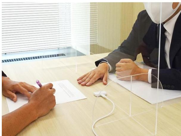
「AmiVoice Front FF01」は、音声のテキスト化に適した高音質での録音を可能にする 2ch マイクデバイスです。サイズは横 5.2cm・縦 2.4cm、重さは 9g と軽量コンパクトで、簡単に持ち運び・設置が可能です。発話者の口元の音声のみを集音する指向性を有しており、聞き取りづらいと言われるマスクやアクリルパネル・ビニールカーテン越しでの会話も、高音質で録音します。
