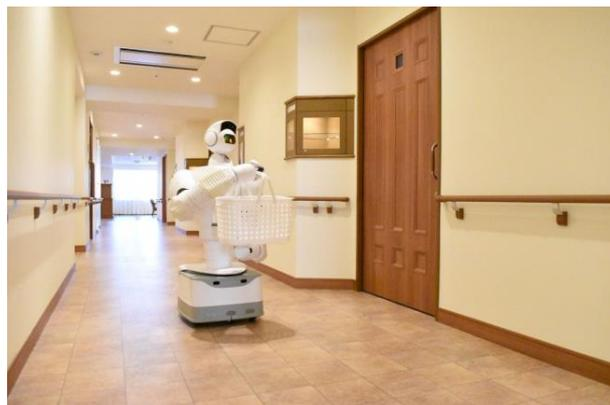
この度、「アイオロス・ロボット」の日本語・英語の音声認識に、アドバンスト・メディアのAI 音声認識エンジンAmiVoiceが採用されました。「車輪のロックを解除して」「スペースを空けて」などの介護スタッフ・入居者の声に従い、各種介護業務をサポートします。
